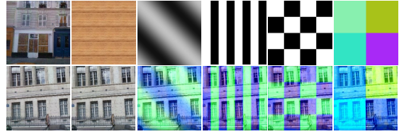
图 10. 通过设置 y_z 为不同的纹理图案来提取隐藏信息。左上角和左下角分别是载密图像和隐藏图像。第一行的其余 5 张图像是 y_z 的纹理图案，它们的底部是从载密图像中恢复的相应结果。
